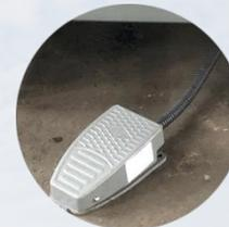
置入钢筋→踩下脚踏开关→虎钳自动夹紧→自动剥肋→自动上丝推进→自动退回复位→虎钳自动松开完成丝头加工
