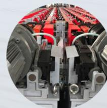
剥肋&倒角、剥肋&滚丝，只需更换机头部分组件，可配线，一机多用。
