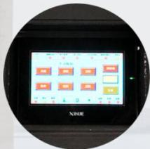
采用PLC控制、触摸屏参数设置可视化操作简单易懂。
