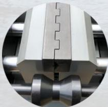
设备整体固件系统采用气动杠杆虎钳保压式持续夹紧，有效避免了因工件未能固定产生的加工次品率和一系列操作安全问题。虎钳口采用优质特殊材质及热处理工艺，是普通虎钳口耐磨耐用5-6倍。
